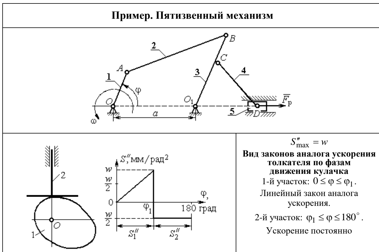
Рис. 3.1. Схема пятизвенного механизма и закон изменения аналога ускорения центрального плоского толкателя
