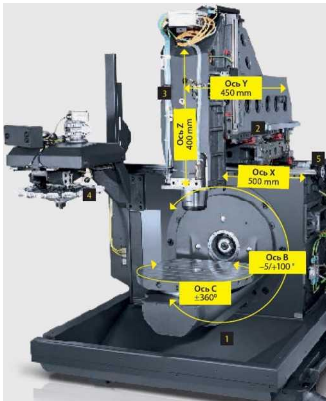
1 - С-образная станина из серого чугуна; 2 - роликовые направляющие качения на всех осях; 3 - мотор-шпиндель; 4 - магазин инструментов; 5 - шаговые двигатели привода подачи Рис. 3 - Вертикально-фрезерный станок с ЧПУ DMU 50
