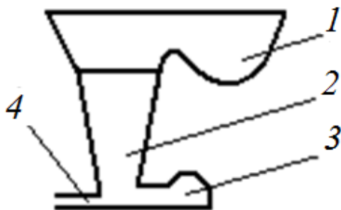
Рис. 4.7. Литниковая система: 1 – литниковая чаша; 2 – стояк; 3 – шлакоуловитель; 4 – питатель
