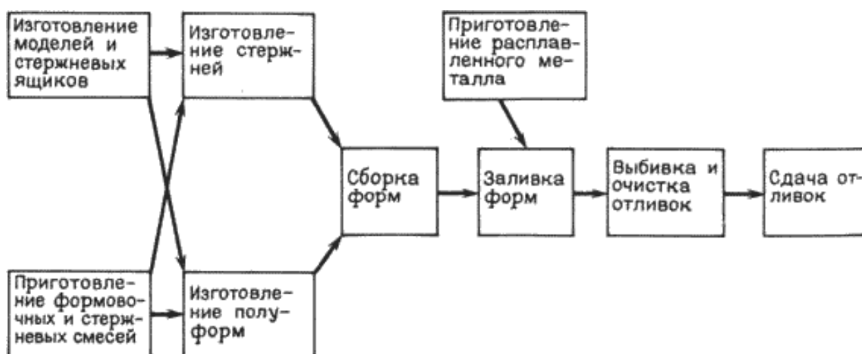
Рис. 5.1. Схема технологического процесса изготовления отливок в песчаных формах
